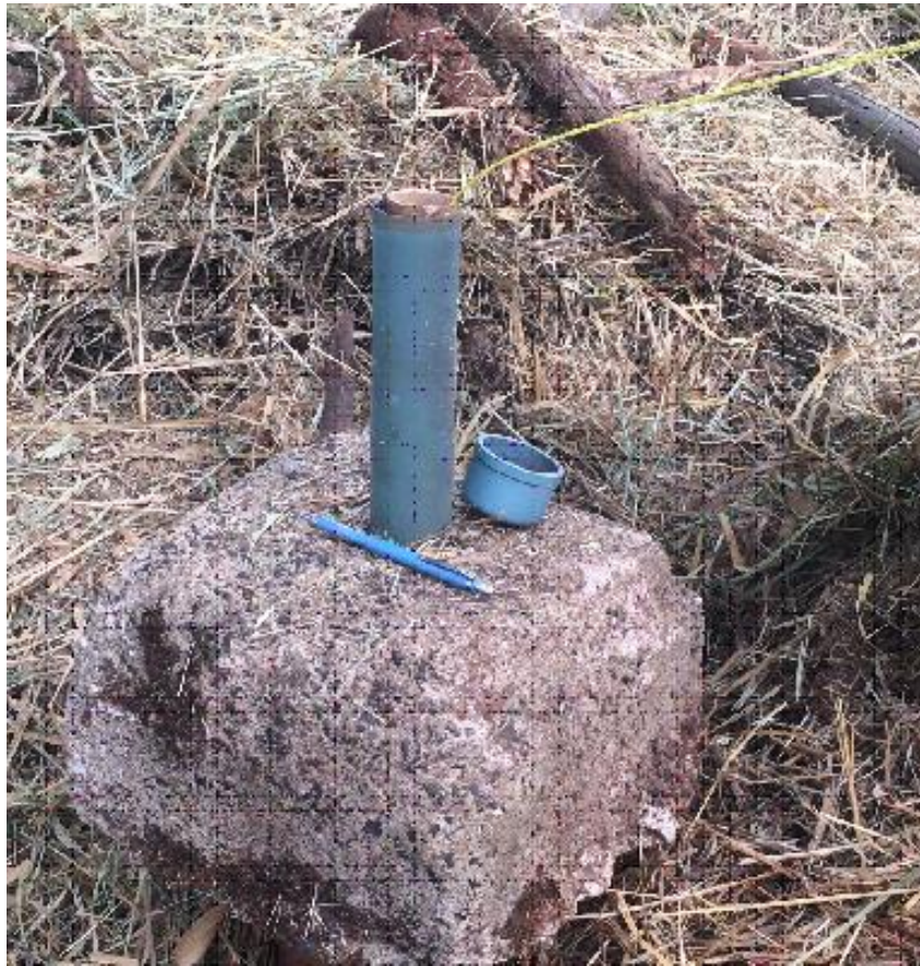
Figura 2 – Piezômetro instalado na área da microbacia
